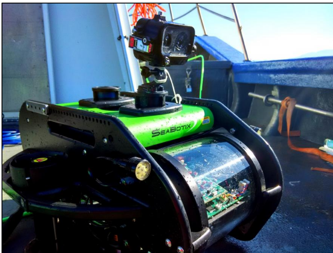
Figura 5. Fotografía del ROV, modelo Seabotix LVB300-5, empleado en los trabajos de inspección visual de los fondos.
