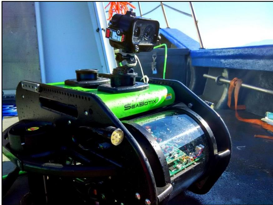
Figura 5. Fotografía del ROV, modelo Seabotix LBV300-5, empleado en los trabajos de inspección visual de los fondos.
